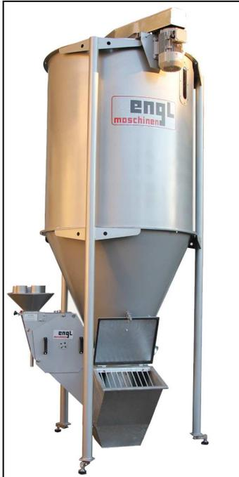
Der **Vertikalmischer** ist der traditionelle Kraffttermischer für trockenes, rieselfähiges Gut. Wir fertigen ihn sowohl als Freimischer bei Säurebeimischungen oder mit Zwangsrohr. Wegen dem "290 mm" großen Schneckendurchmesser und "150 mm" niedriger Wendelsteigung mischt der VM besonders schonend und kraftsparend. Durch die Segmentbauweise sind Ausläufe zu den Standfüßen und des Motors bei der Montage flexibel. Serienkonus 62°
