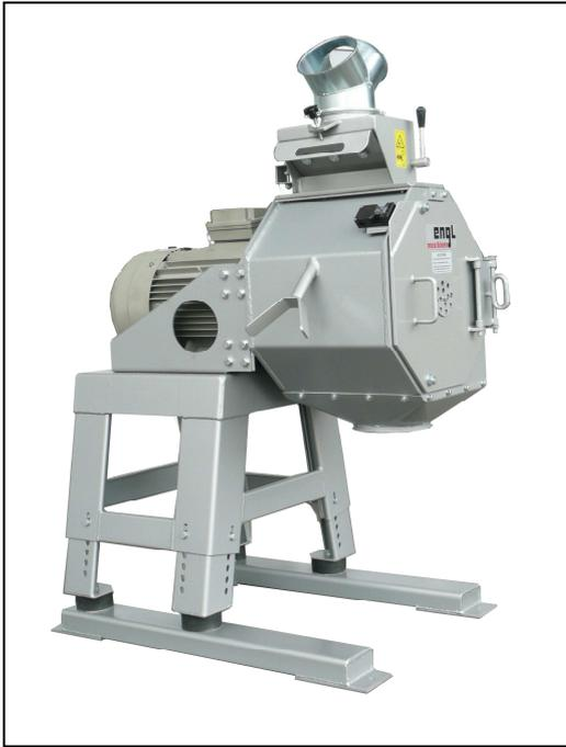
Die Mühle „SM-90“, „hat einen Tangenteneinlauf mit mechanischer Einlaufmengenregulierung. Mahlgehäuse und Motor haben eine Flansch-/ Stativ-Verbindung. Der aufklappbare Frontdeckel mit Sicherheitsschalter und die Siebspannvorrichtung vereinfachen den Siebwechsel. Mühle mit Filteranschluss 200mmØ + 3m Filter.
