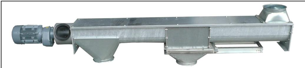
Trogförderschnecke 200mmØ; Ein- und Auslauf 200mmØ;Zwischenauslauf mit Horizontalschieber und Sammeltrichter reduziert auf 200mmØ; Antrieb Getriebemotor mit Klauenkupplung
